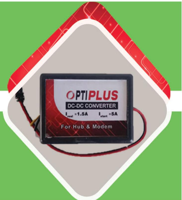
تجهیزاتی مانند هاب یا مودم که با ولتاژ ۹ یا ۵ ولت کار می کنند را با "تبديل ۱۲ به ۵ یا ۹ ولت" به دستگاه برق اضطراری متصل نمایید برای جلوگیری از افت ولتاژ در مسیرهای طولانی سیم سمت ۱۲ ولت را از دستگاه برق اضطراری سیم کشی کرده و تبدیل را کنار هاب یا مودم قرار دهید.
